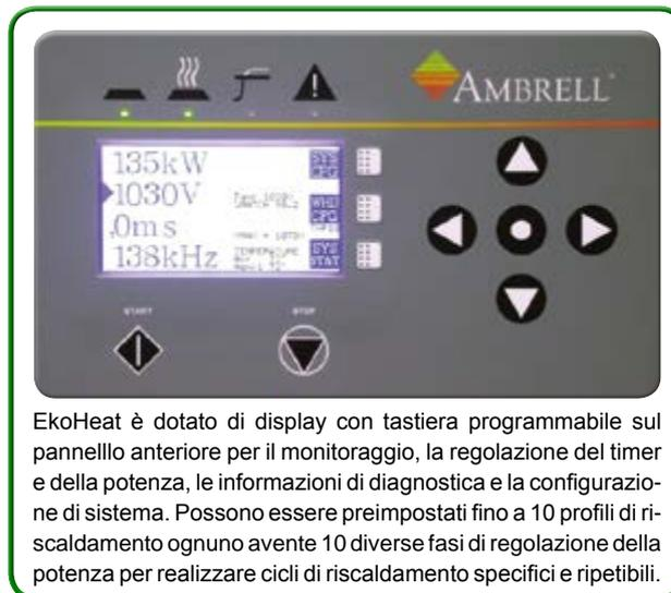
EkoHeat è dotato di display con tastiera programmabile sul pannello anteriore per il monitoraggio, la regolazione del timer e della potenza, le informazioni di diagnostica e la configurazione di sistema. Possono essere preimpostati fino a 10 profili di riscaldamento ognuno avente 10 diverse fasi di regolazione della potenza per realizzare cicli di riscaldamento specifici e ripetibili.
